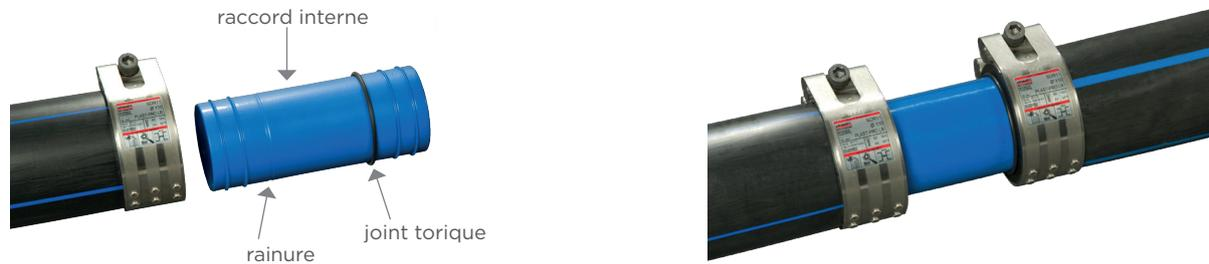
Libérez 100 mm de tube. Pliez légèrement les extrémités des tubes sur le côté et glissez le raccord de réparation jusqu'au joint torique dans l'une des deux extrémités. Pousser les colliers joint franc sur les bouts de tube.
