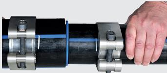
Pousser le deuxième tube jusqu'à la butée sur la réduction.
